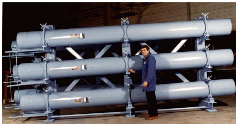
Piston accumulateurs of 150 liters / 40 gallons each.
