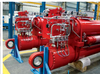
Cilindros para compensadores AHC 1 000 Kips SA 440, Curso 7 000 mm + acumulador BP 1 140 litros Drill String Compensator Cylinders 1 000 Kips SA 440, Stroke 7 000 mm" + HP accumulator 1 140 liters
