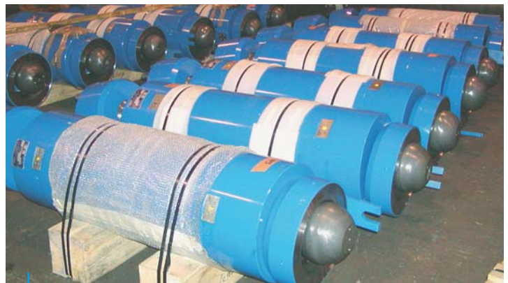
Tuneladora Pajares (Espanha) Cilindros hidráulicos DA 360 x 240, Curso 650 mm Pajares tunnel boring machine (Spain) DA Hydraulic Cylinders 360 x 240, Stroke 650 mm
