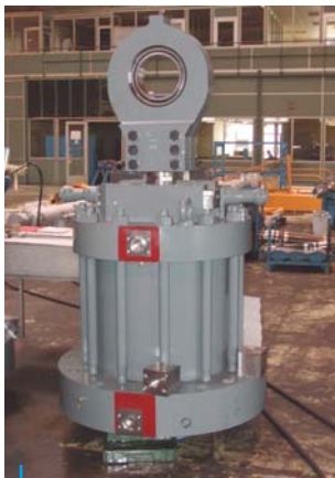
Projeto Tong Bai (China) 8 Cilindros de turbina 750 x 250, Curso 440 mm com dispositivo de bloqueio + 8 Cilindros hidráulicos DA 560 x 200, Curso 1 913 mm
