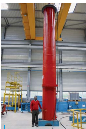
1 Acumulador de Pistão SA 820, Curso 7 650 mm 1 Piston Accumulator SA 820, Stroke 7 650 mm
