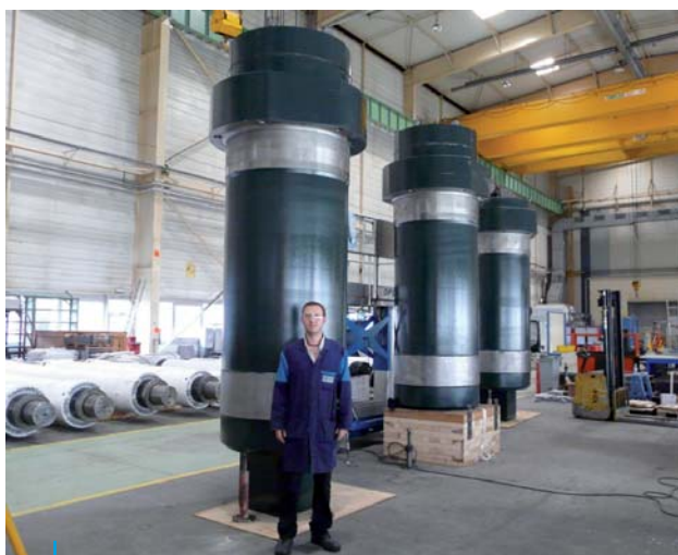
Cilindros hidráulicos para prensas de forja SA dia. da haste 740, Curso 2 050 mm Forging Presses Hydraulic Cylinders SA rod dia. 740, Stroke 2 050 mm
