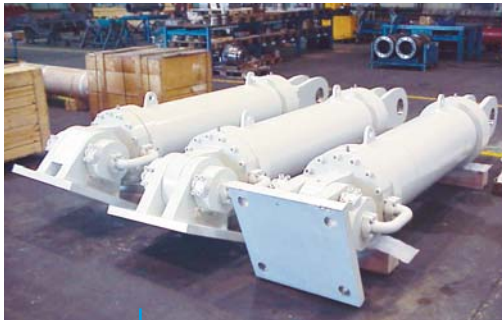
Barragem de Yele (China) Hastes com revestimento KERADOUCE® - 4 Cilindros hidráulicos DA 440 x 200, Curso 1 659,71 mm Dam of Yele (China) Rods with KERADOUCE® coating - 4 DA Hydr. Cyl. 440 x 200, Stroke 1 659,71 mm
