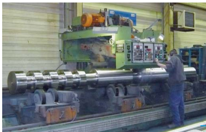
Politriz centerless Diâm. 60 a 500 mm Comprimento: 10 000 mm Peso admissível: 17 000 kg Centerless polisher Dia. 60 up to 500 mm Length: 10 000 mm Allowable weight: 17 000 kg
