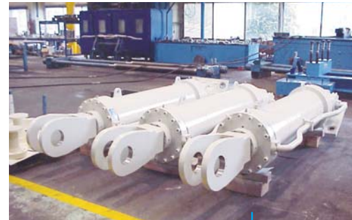
Barragem de Yele (China) Hastes com revestimento KERADOUCE® - 4 Cilindros hidráulicos DA 440 x 200, Curso 1 659,71 mm Dam of Yele (China) Rods with KERADOUCE® coating - 4 DA Hydr. Cyl. 440 x 200, Stroke 1 659,71 mm
