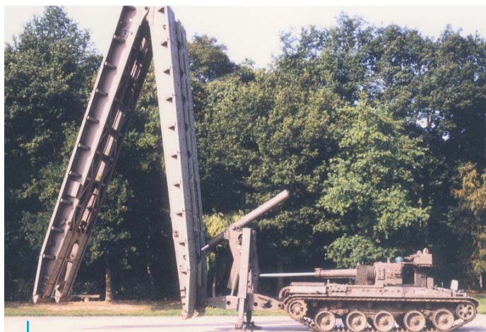
Instalador de ponte móvel Cil. hydr. DA 240 x 120, Curso 2 070 mm - Cil. hydr. DA 240 x 120, Curso 3 070 mm Army mobile bridge Hydr. Cyl. DA 240 x 120, Stroke 2 070 mm - Hydr. Cyl. DA 240 x 120, Stroke 3 070 mm
