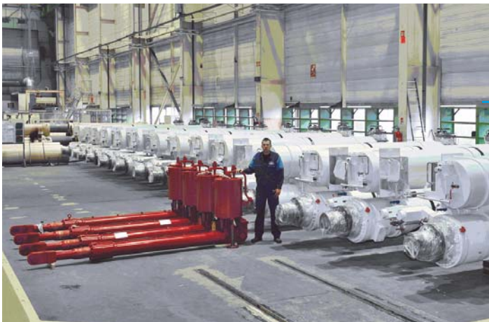
Cilindros brancos: 14 Cilindros tensionadores de riser cabo elétrico de perfilagem 250 Kips DA 540 x 480, Curso 3 810 mm + acumulador AP dia. 580 mm, Curso 3 710 mm; 980 litros + acumulador BP 305 litros
