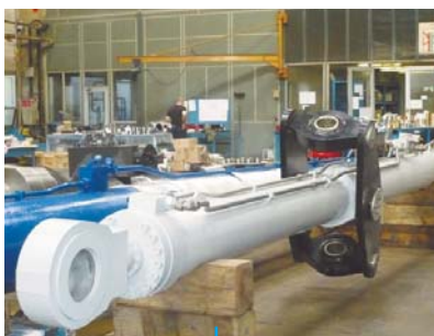
8 cilindros hidráulicos DA 300 x 130, Curso 5 600 mm 8 Hydraulic Cylinders DA 300 x 130, Stroke 5 600 mm
