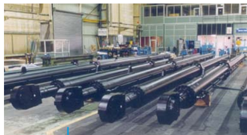
10 cilindros hidráulicos para comportas radiais DA 400 x 160, Curso 17 500 mm com hastes com revestimento KERADOUCE®
