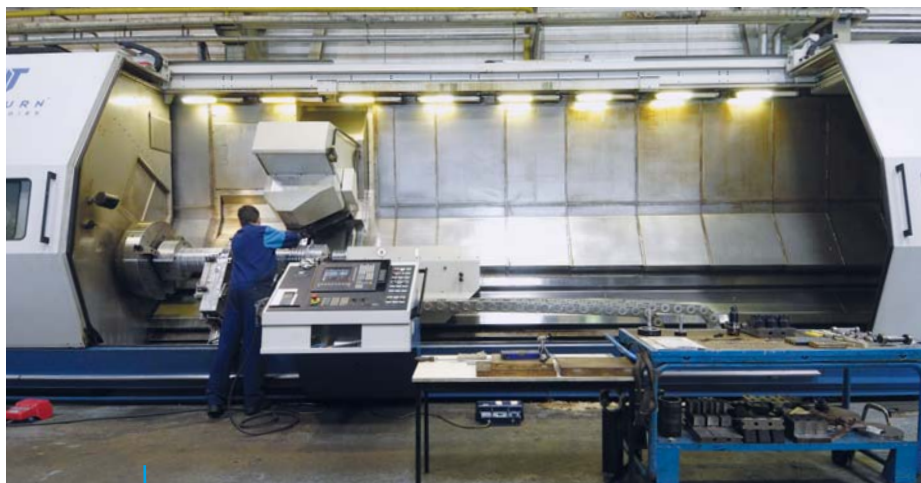
Centro de torneamento CNC 5 eixos Balanço sobre a corredeira superior: 900 mm ; Distância máxima do centro: 6 500 mm 5-AXIS CNC lathe Swing over top slide: 900 mm; Maximal center distance: 6 500 mm
