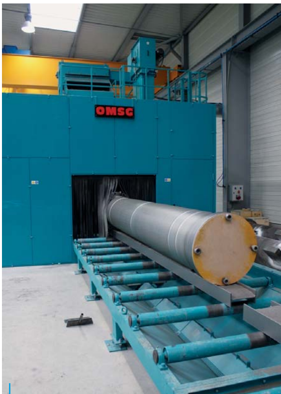
Novo unidade de areamento - 30 metros de comprimento New in-house sandblasting equipment - Length 30 meters
