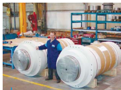
Cilindro Prensador DA 780 x 750, Curso 1 620 mm Press Cylinder DA 780 x 750, Stroke 1 620 mm
