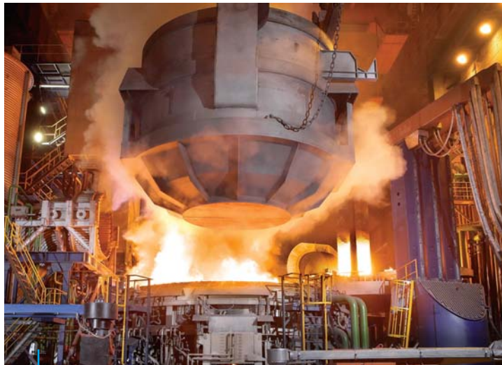
Forno a arco elétrico Electric arc furnace
