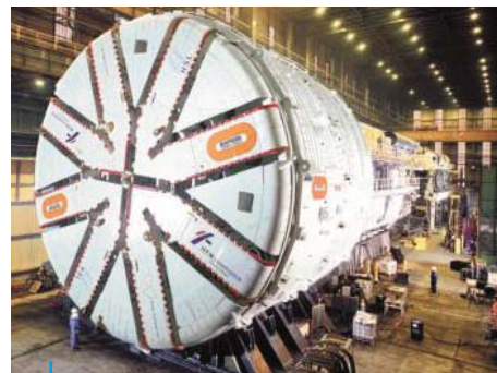
Tuneladora do túnel de Groene Hart, dia. 14,8 metros Groene Hart tunnel boring machine dia. 14,8 meters
