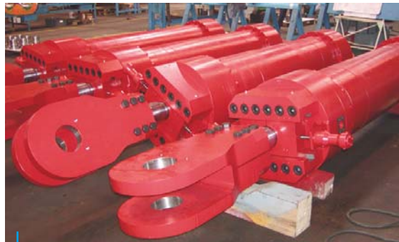
Barragem hidrelétrica de Baglihar (Índia) 6 Cilindros de turbina 380 x 240, Curso 278 mm com dispositivo de bloqueio Hydroelectric Dam Baglihar (India) 6 Turbine Cylinders 380 x 240, Stroke 278 mm with locking device
