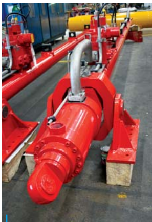
Cilindros de haste dupla para compensadores AHC 200 x 175 x 100, Curso 7 800 mm + sistema de medição SMIK® certificado ATEX Active Heave Compensator Double Rod Cylinders 200 x 175 x 100, Stroke 7 800 mm + ATEX certified SMIK® measuring system
