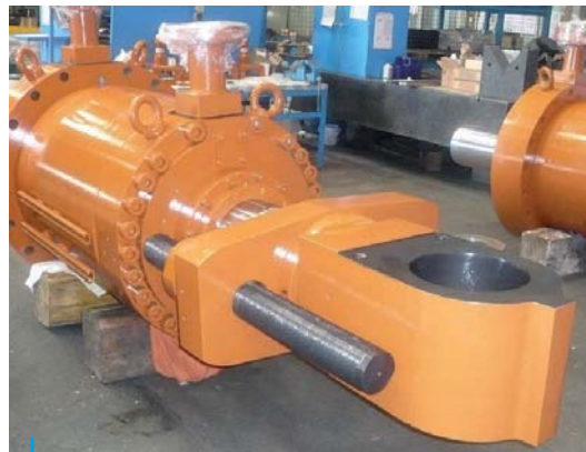
Barragem de Pudugou (China) 6 servomotores 670 x 275, Curso 549 mm Dam of Pubugou (China) 6 Servomotors 670 x 275, Stroke 549 mm
