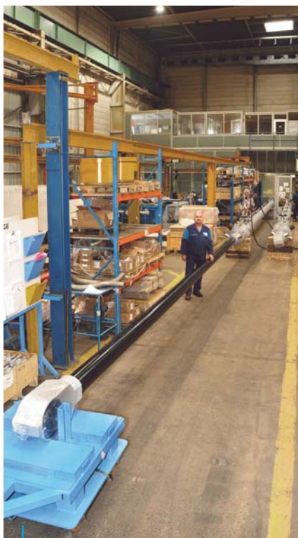
4 cilindros para comportas radiais DA 340 x 190, Curso 13 100 mm com hastes com revestimento KERADOUCE® 4 Radial Gates Cylinders SA 340 x 190, Stroke 13 100 mm with rods in KERADOUCE® coating
