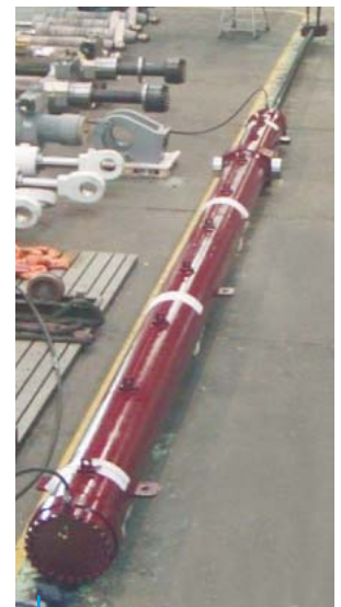
Cilindro hidráulico DA 500 x 200 Curso 12 250 mm Haste com revestimento KERADOUCE® DA Hydraulic Cylinder 500 x 200, Stroke 12 250 mm, Rod in KERADOUCE® coating
