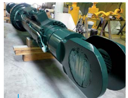
Cilindro hidráulico de dragagem offshore 1 Cilindro DA 500 x 330, Curso 8 300 mm Offshore Dredging Hydraulic Cylinder 1 DA Cylinder 500 x 330, Stroke 8 300 mm
