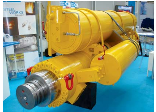
Tensionadores Wireline DA 540 x 480, Curso 3 810 mm + Acumulador de Alta Pressão 580, Curso 3 710 mm + Acumulador de Baixa Pressão 304, Curso 3 450 mm Wireline Tensioners DA 540 x 480, Stroke 3 810 mm + HP Accumulator dia. 580, Stroke 3 710 mm + LP Accumulator dia. 304, length 3 450 mm
