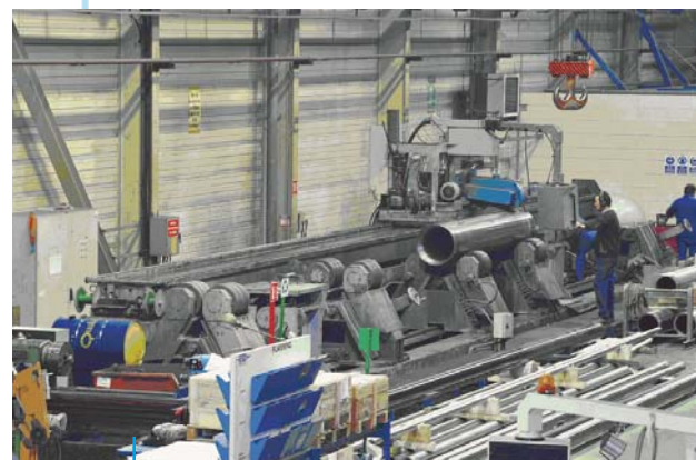
Retífica: Diâmetro: 900 mm ; Comprimento: 30 000 mm Uma das maiores retificas da Europa! Grinding machine: Diameter: 900 mm; Length: 30 000 mm One of the largest grinding machines in Europe !
