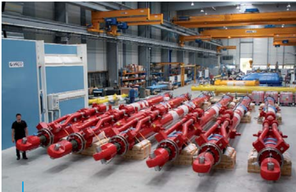
12 Cilindros hidráulicos 5 000 Kips - DA 560 x 230, Curso 15 240 mm + sistema de medição SMIK® certificado ATEX e revestimento de haste LaserteK® 12 Hydraulic Cylinders 5 000 Kips - DA 560 x 230, Stroke 15 240 mm + Microwave measuring system & LaserteK® rod coating
