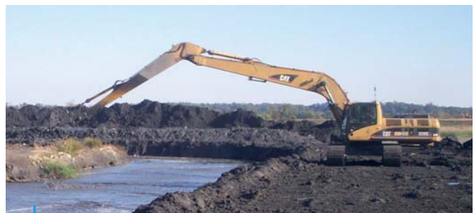
Haste com revestimento KERADOUCE® operando em meio poeirento ácido e abrasivo. Excavator Cylinder Rod in KERADOUCE® coating working in a fly ash, abrasive and acidic environment
