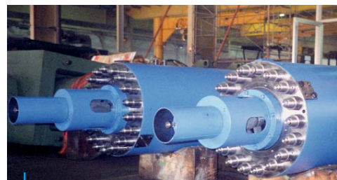
2 Cilindros hidráulicos especiais de dupla ação para prensas DE 570 x 560, Curso 870 mm com válvula de prefill traseira
