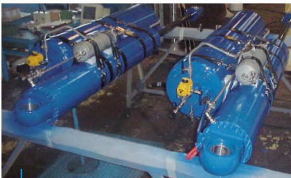
6 Cilindros tensionadores para perfuração 222 x 82, Curso 372 mm com acumuladores de alta e baixa pressão 6 Drilling Tensioner Cylinders 222 x 82, Stroke 1 372 mm with high and low pressure accumulators
