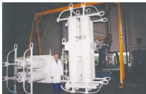
8 Acumuladores de Pistão dia. 4 020 x 1 560 x 1 560 mm Porta-aviões Charles de Gaulle 8 Piston Accumulators Dia. 4 020 x 1 560 x 1 560 mm Aircraft carrier Charles de Gaulle
