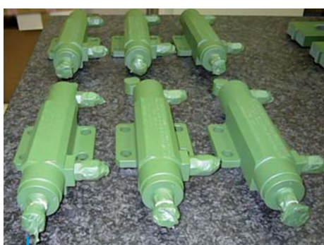
Cilindros de tiro DA 32 x 18, Curso 80 mm Ignition Hydraulic Cylinders DA 32 x 18, Stroke 80 mm
