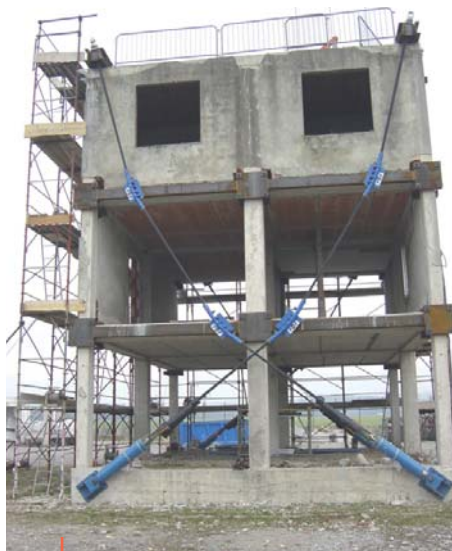
Amortecedores pré-esforçados, tipo "Spider" - Design patenteado Preloaded spring damper, type « Spider » Patented design
