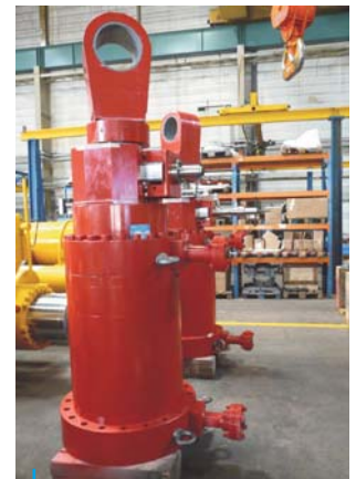
Projeto Revelstoke (British Columbia, Canadá) Servomotores DA 600 x 240, Curso 580 mm
