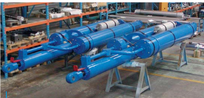
73 Tensionadores de produção de riser Dia. 260 x 100, Curso 6 403 mm com 1 acumulador de baixa pressão (20 gal.) + 2 acumuladores de alta pressão (110 gal. cada um) 73 Production Riser Tensioners Dia. 260 x 100, Stroke 6 403 mm with 1 low pressure accumulator (20 gal.) + 2 high pressure accumulators (110 gal. each)
