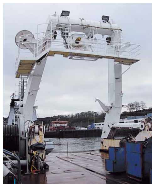
Cilindros hidráulicos para guinchos 320 x 180, Curso 3 200 mm Hydraulic Cylinders for lifting winches 320 x 180, Stroke 3 200 mm
