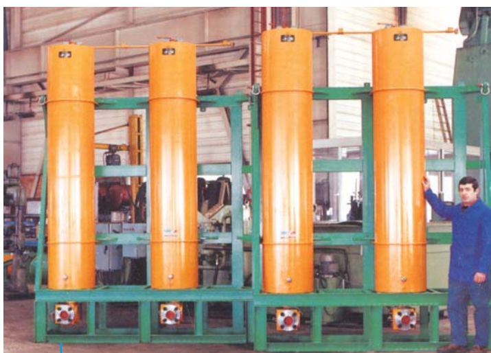
12 Acumuladores de Pistão dia. 420, Curso 1 870 mm - Mesa de teste 12 Piston Accumulators dia. 420, Stroke 1 870 mm - Test table
