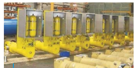
Cilindros para Sistemas de Instalação Vertical 32 Cilindros hidráulicos DA 280 x 180, Curso 550 mm com sistema de medição Vertical Lay System Cylinders 32 Hydraulic Cylinders DA 280 x 180, Stroke 550 mm with measuring system
