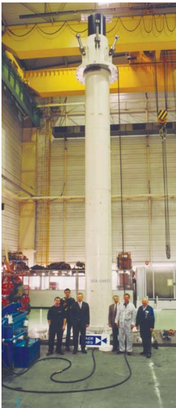
Forno vertical para a fundição de placas de alumínio 1 Cilindro hidráulico SA dia. da haste 790 mm, Curso 9 700 mm Haste com revestimento KERADOUCE® Vertical cast furnace for aluminum platen 1 SA Hydraulic Cylinder rod dia: 790 mm, Stroke 9 700 mm Rod with KERADOUCE® coating
