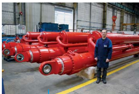
Cilindros para compensadores AHC 1 000 Kips SA 440, Curso 7 000 mm + acumulador BP 1 140 litros Drill String Compensator Cylinders 1 000 Kips SA 440, Stroke 7 000 mm" + HP accumulator 1 140 liters
